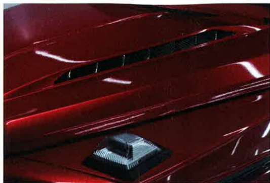
Die Motorhaube ist komplett aus Carbon gefertigt, bis auf die seitlichen Auslässe, aber in Wagenfarbe lackiert.
